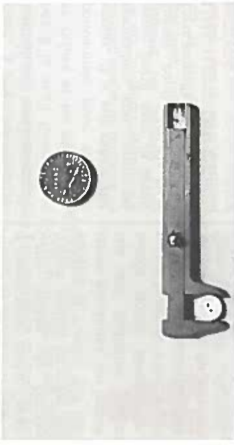
pied à coulisse, gradué en «lignes», servant au contrôle du calibrage des boutons
